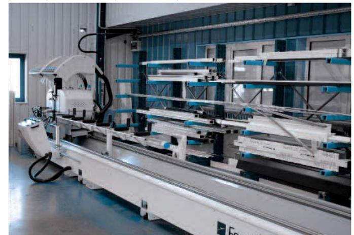
Machine de coupe pour l'aluminium avec double têtes numérique
