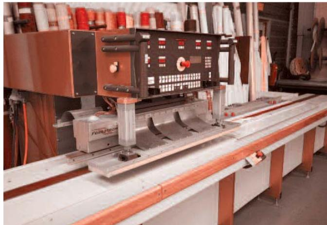
Machine haute fréquence (HF) sur rail 20 kg avec guide laser
