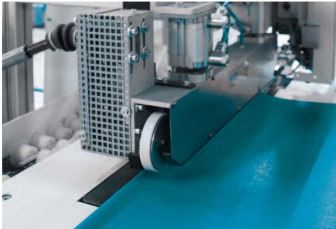
Machine de thermosoudage à fer chaud entièrement automatique
