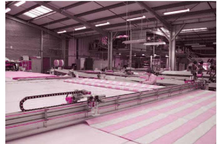
Automate de confection avec table soufflante et banc d'équerrage automatique
