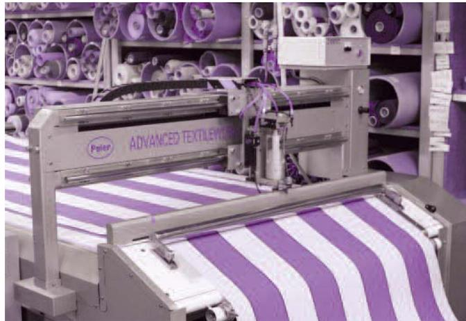
Machine de coupe automatique à ultrason dans les deux sens
